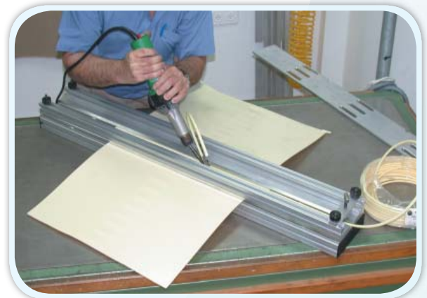
Stabschweißen von Profilen
